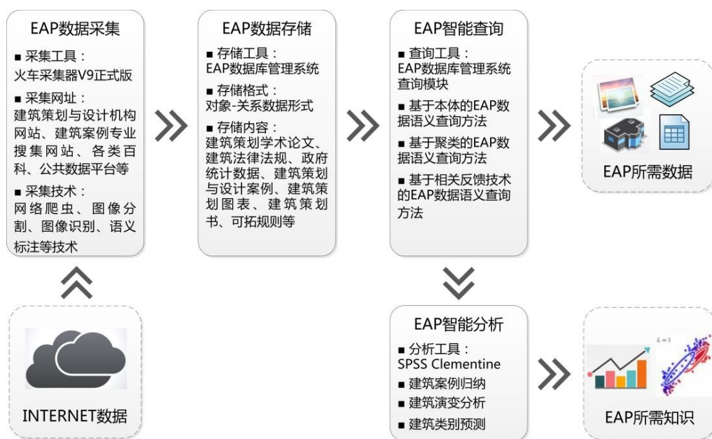
图 3-5 互联网背景下可拓建筑策划数据挖掘的总体框架
