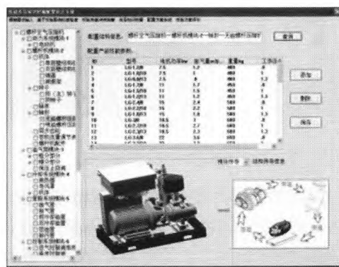
图5 螺杆空压机相似实例检索子系统输出
